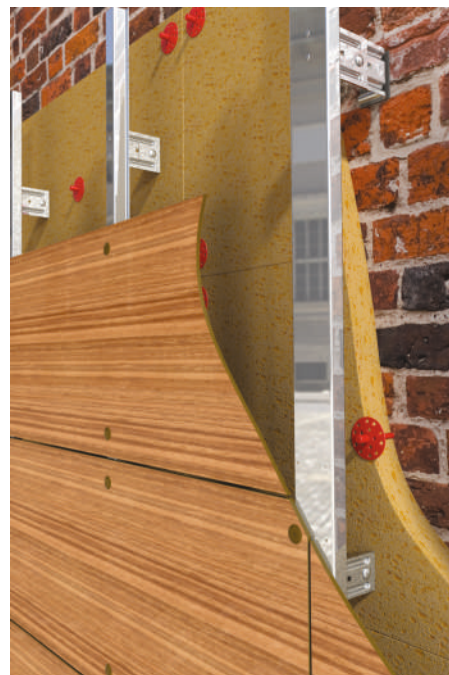
Фрагмент фасада “стандартная” схема крепления
